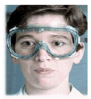
GOGGLES CONTACT THE FACE ALL AROUND, ESPECIALLY OVER THE EYES AND HAVE INDIRECT VENTING (NO HOLES) WHILE PROVIDING THE ABSOLUTE MINIMUM OF STYLE.
